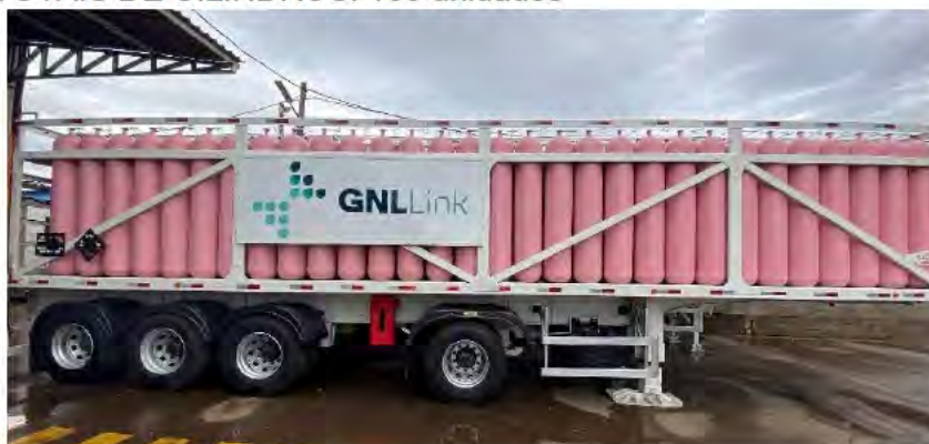
Figura 3: Carreta de GNC com cilindros interligados
